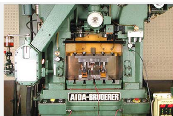
精密金型を自動プレス機にセット、ハイスピードスタンピング
